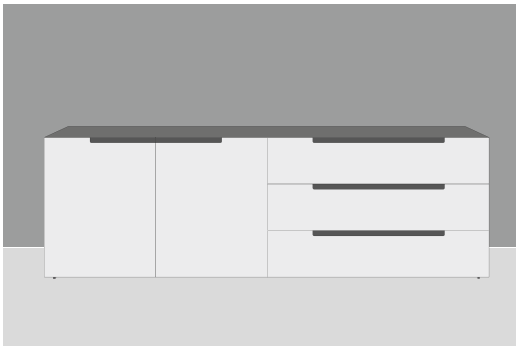
Bodenstehend mit kleinen Stellfüßen, 2,5 cm hoch bei Drehtüren und Schubkästen, 3,5 cm hoch bei Schiebetüren
