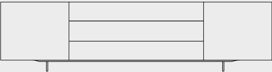
Eingerückte Kufen bei 150,0 - 260,0 cm Sideboardbreite mit 2 Kufen.
